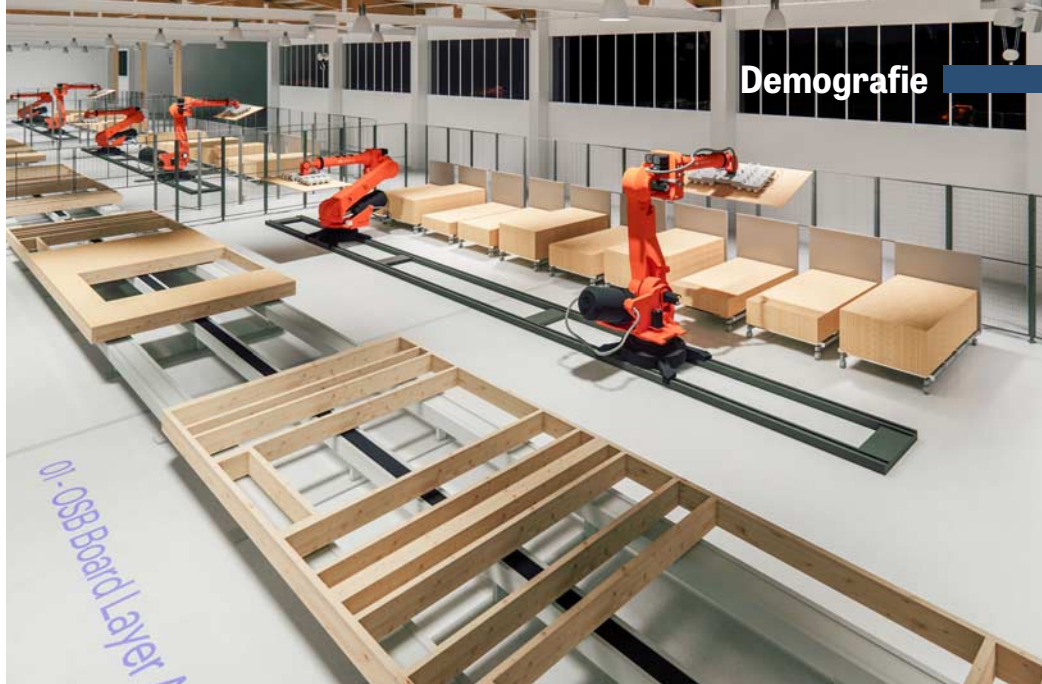
So wird die Fertigung beim deutsch-österreichischen Wohnbau-Start-up Gropiplus aussehen: Roboter sollen die Wandelemente vollautomatisch binnen 17 Minuten im Werk vorfertigen.
